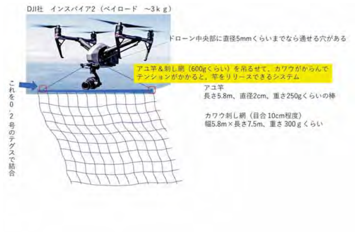
図1. カワウを上空から追い込む仕組み
