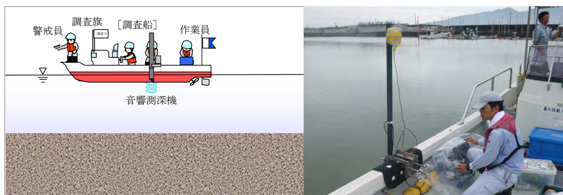
図 9 地形調査 (音響測深機) 作業状況
