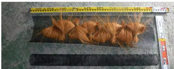
図 41 パームを収容するプラスチックネット（上）とメッシュパイプ（下）
