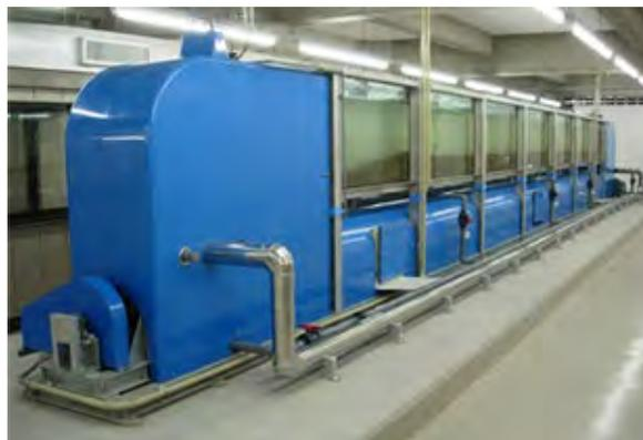
図40 実験で使用した大型回流水槽 (水産技術研究所 所有)
