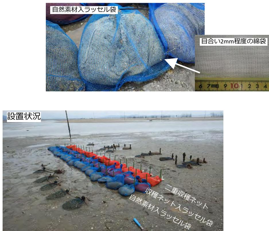
図 54 補足実験での網袋設置状況
