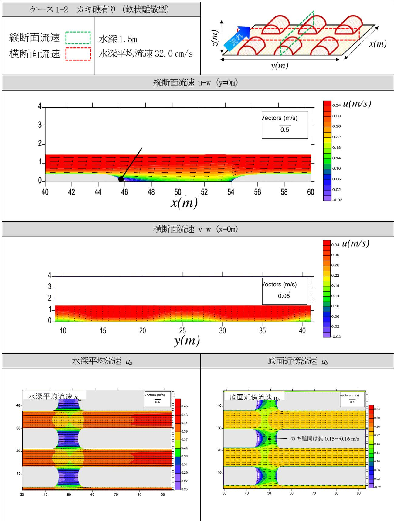
図 23 ケース 1-2 カキ礁有り (水深 1.5m、水深平均流速 32.0 cm/s) のシミュレーション結果 (1/2)
