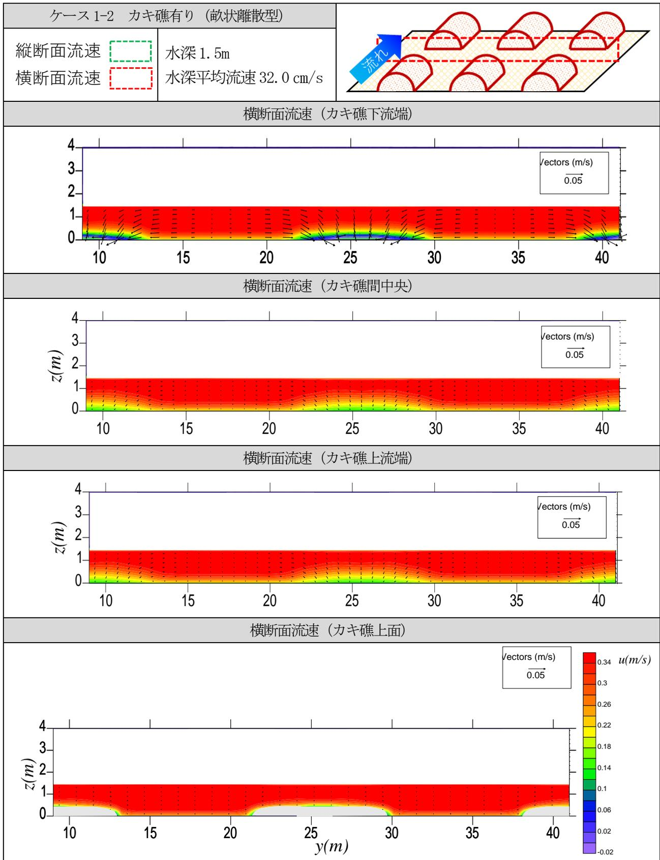
図 24 ケース 1-2 カキ礁有り (水深 1.5m、水深平均流速 32.0 cm/s) のシミュレーション結果 (2/2)
