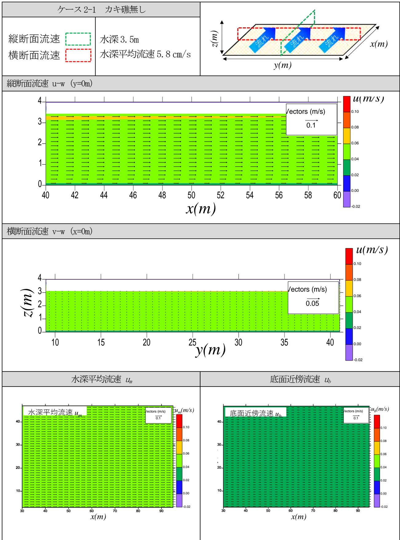
図 25 ケース 2-1 カキ礁無し (水深 3.5m、水深平均流速 5.8 cm/s) のシミュレーション結果
