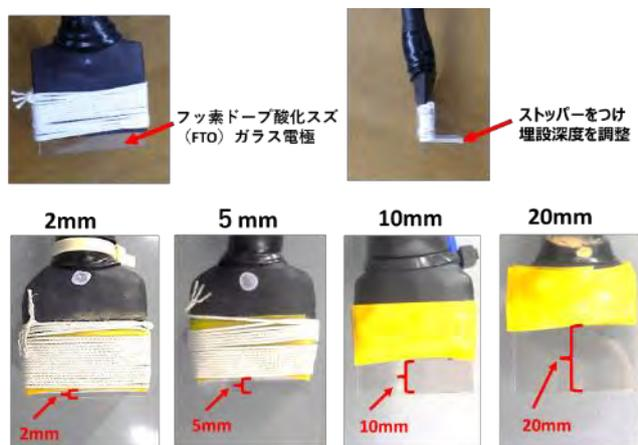
図 1-1 埋設深度を調整したガラス電極
