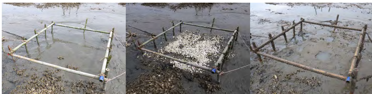
図 16 カキ殻混じり泥場実験区のカキ殻散布状況（左：散布前、中：散布直後、右：散布 2 か月後）
