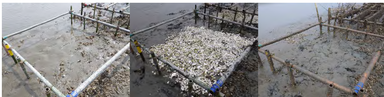
図 15 泥場実験区のカキ殻散布状況（左：散布前、中：散布直後、右：散布 2 か月後）
