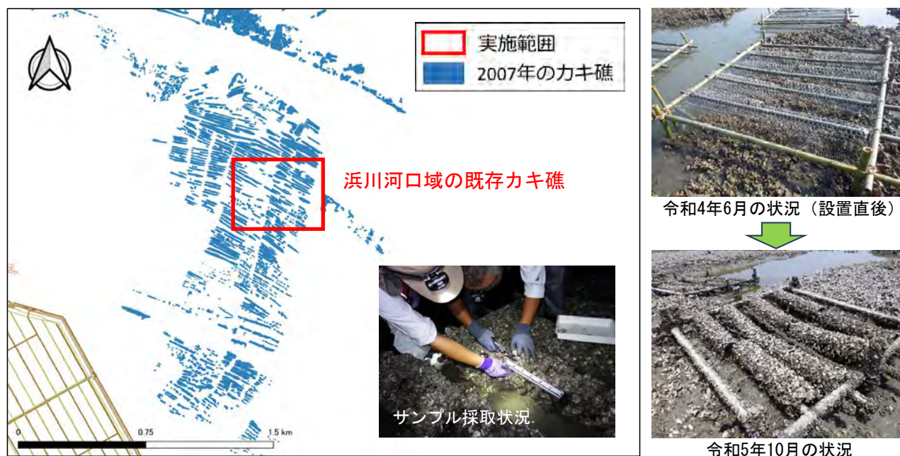
図6 令和4年度設置 金網ロール式着生材の着生量モニタリングの概要
