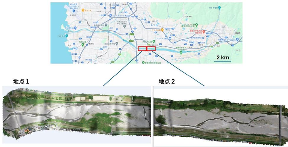
図5. 重信川下流域で撮影した3次元画像を地点1、2に分割したところ。全撮影区間は約2 km。画像解像度は、1ピクセル=2 cmとした。
