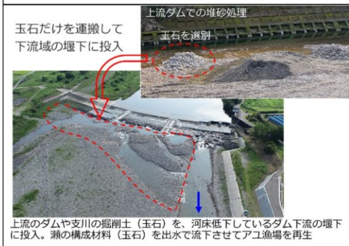
参考事例②：ダム湖等で発生した玉石を堰直下に投入（物部川_町田堰）
