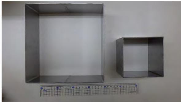
図 18 方形枠(左は、アサリ生息状況調査に使用する 20 cm 方形枠、右は底質調査に使用する 10 cm 方形枠)
