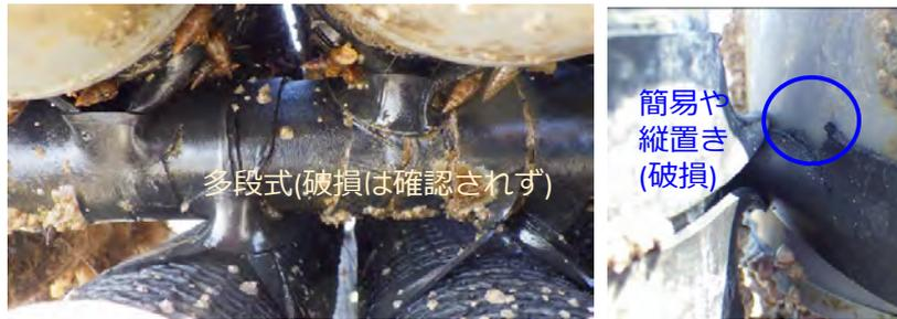
図 26 ゴムバンドの破損状況(多段式では確認されず、多段式(簡易)や縦置きで発生)
