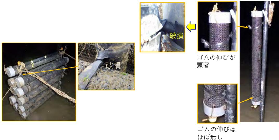
図 31 多段式(簡易 左)と縦置き(右)におけるゴムバンドの状況(破損あり)
