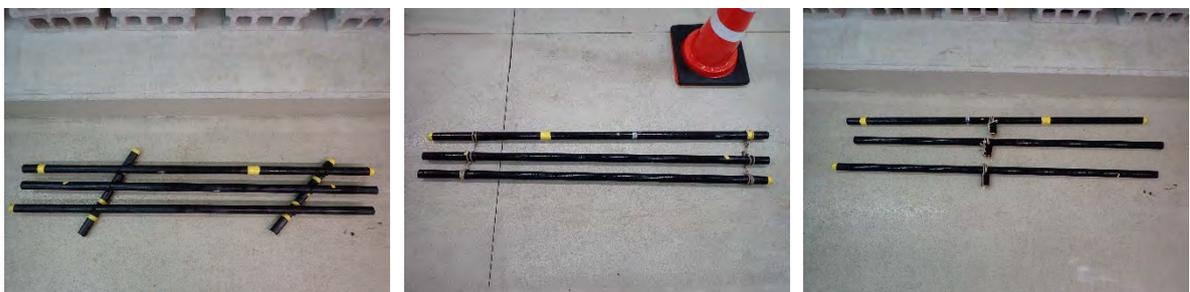
図26 各形状における離底器の写真 (左: 筏型; 中: 簾型; T字型)
