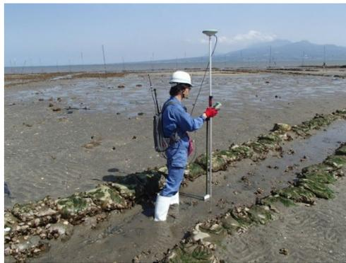
図7 地形調査 (RTK-GPS) 作業状況
