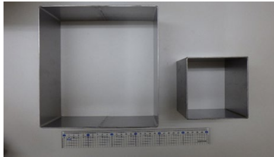
図 17 方形枠(左はアサリ生息状況調査に使用する 20 cm角、右は底質調査に使用する 10 cm角)
