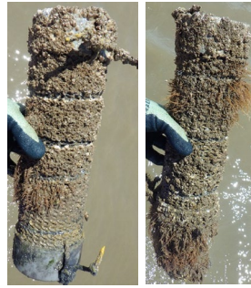
図 44 4号地区に設置したネトロンパイプにおける付着状況(左 0 cm高、右 40 cm高)
