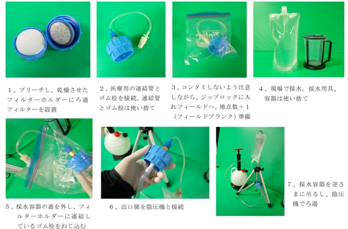
図3 山中手法（一部改変）における採水からろ過までの手法
