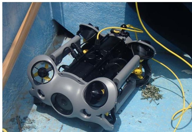
写真2.使用した水中ドローン(M2S (CHASING 社製))
