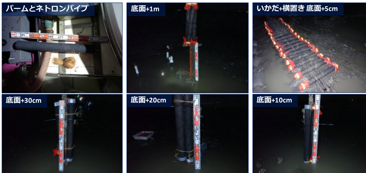
図25 実験区に設置したパーム入りネトロンパイプの様子
