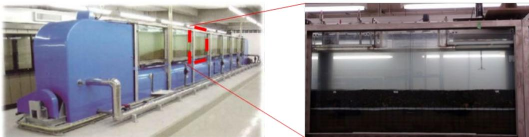
図22 大型回流水槽（右写真は実験で使用する約2mの観測区間）
