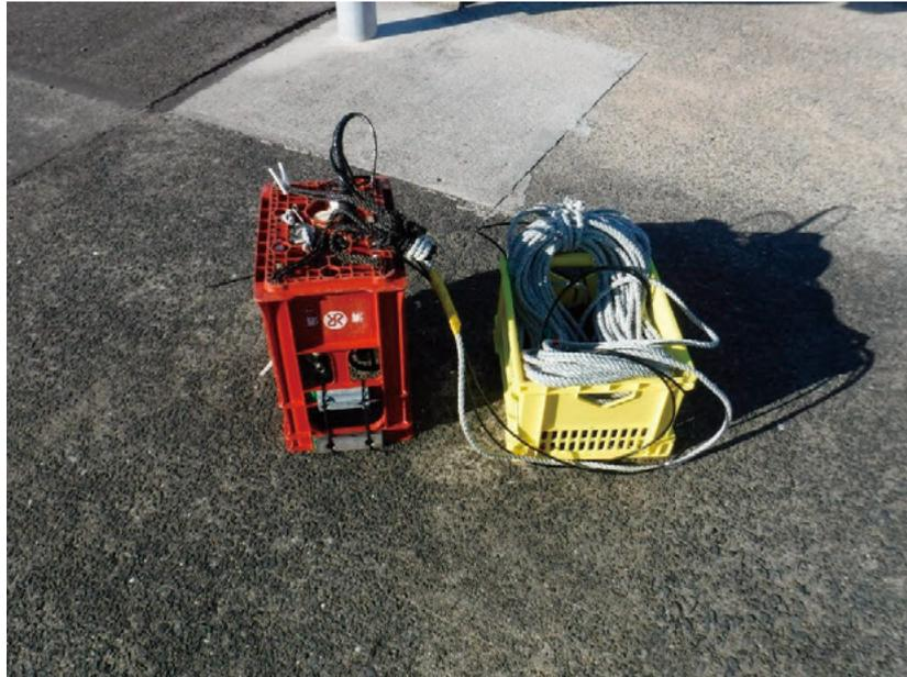
図 5. 有害赤潮プランクトンセンサーと多項目水質計および採水器
