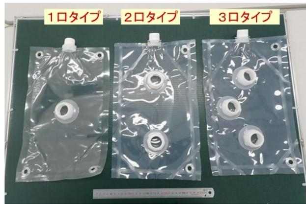
写真 1 溶出口を増設したプラバッグ施肥具
