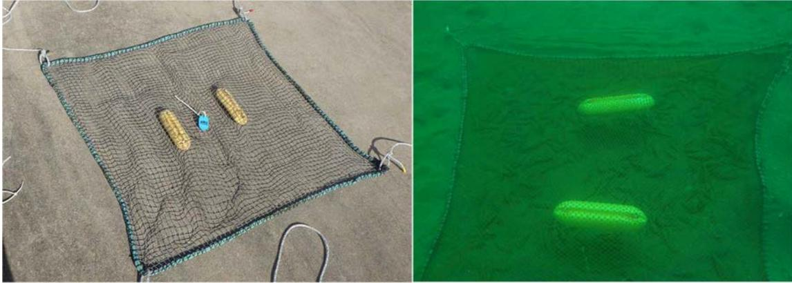
写真1 被覆網の構造と水中での網なり
