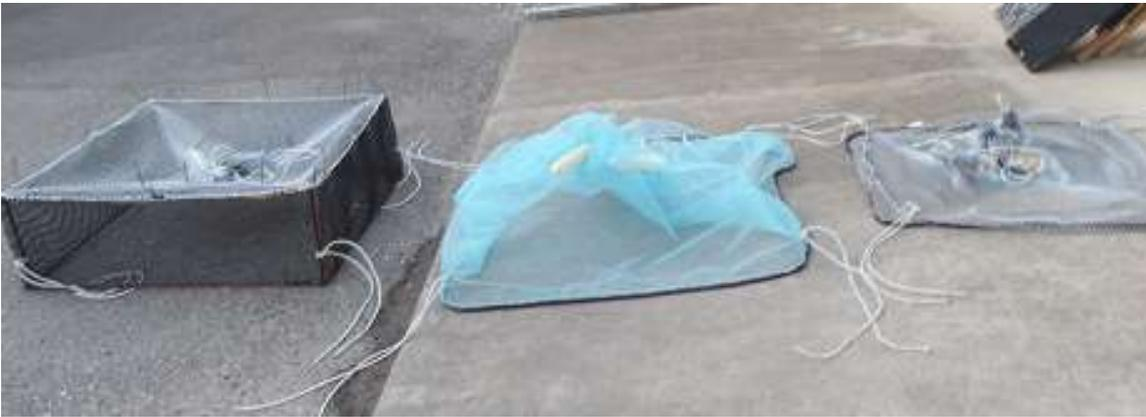
写真2 鉄筋カゴ(右)、モジ網 4mm(中央)、ナイロンラッセル 15mm 網(左)
