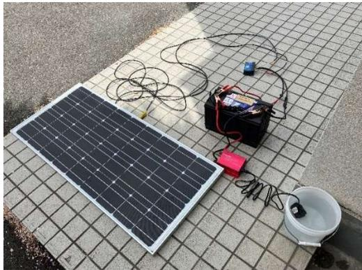
図1. バッテリーの作動時間比較試験の一例
