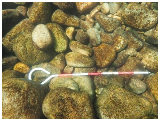
図 7 造成前の長田の瀬における河床の様子 (1 目盛 5 cm)
