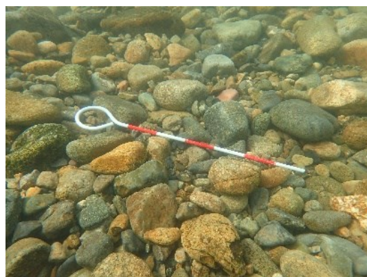
図 8 造成後の長田の瀬における河床の様子 (1 目盛 5 cm)
