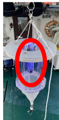
図 23 本調査で使用したライトトラップ(赤丸部分が水中灯)
