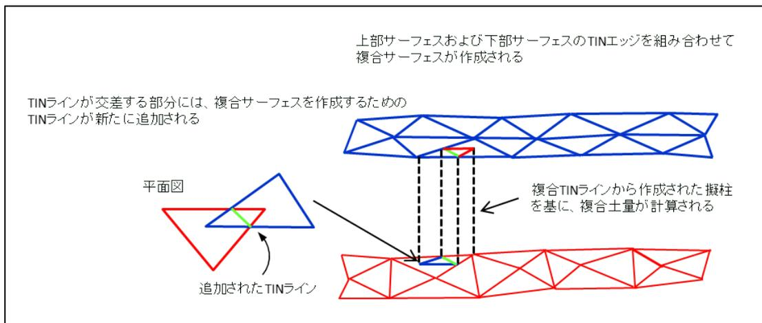
図- 2.7 プリズモイダル法の概念図
