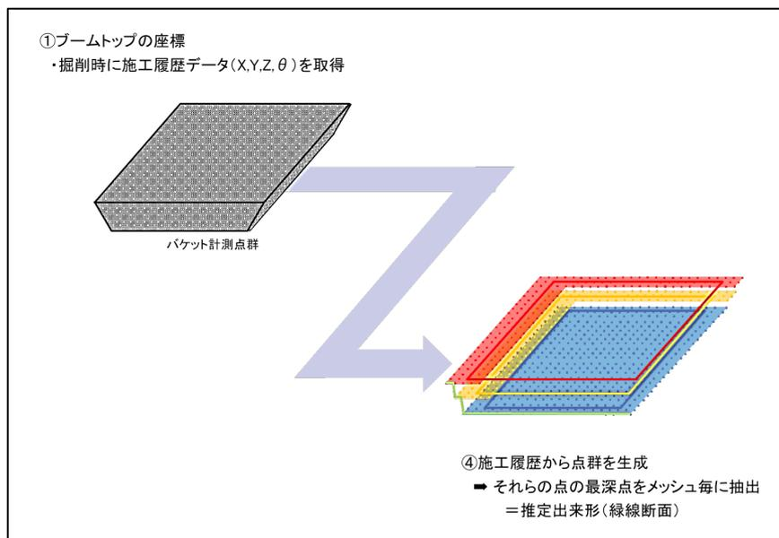
図- 4.1 施工履歴データからの点群生成
