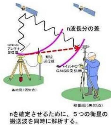
図- 1.3 RTK-GNSS
