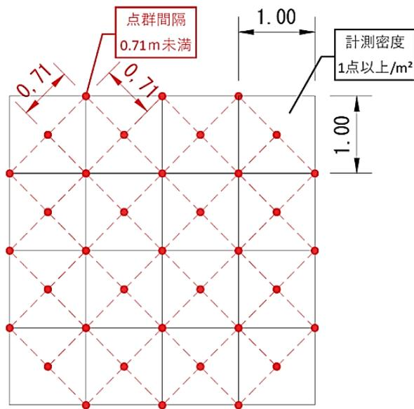
1.0m 平面格子あたり 1 点以上の点群データが得られるようにグラフバケット範囲内の点群間隔を 0.71m 未満に設定する。
