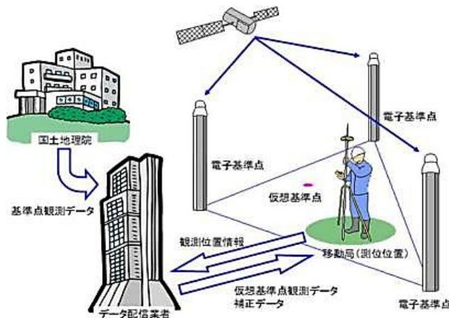
図- 1.4 ネットワーク型 RTK-GNSS
