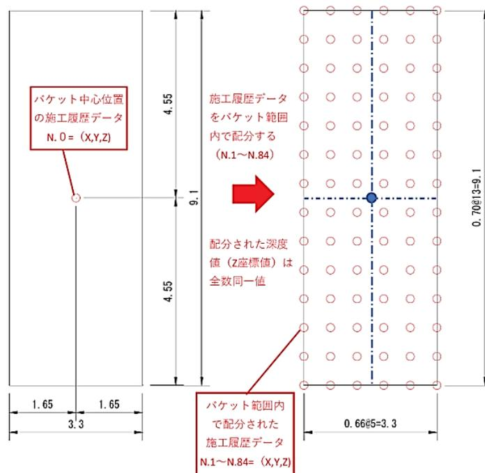
図- 4.3 施工履歴データ分配図
