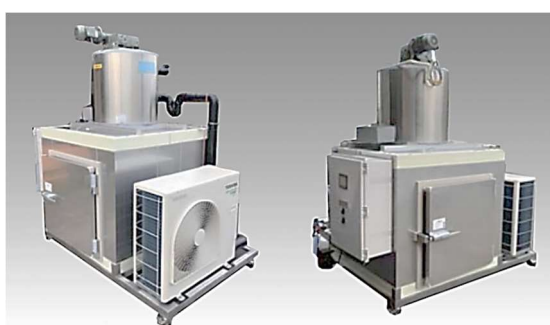
写真 4-27 導入した製氷機
