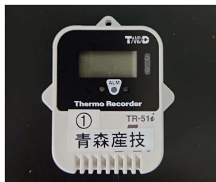
写真 4-31 株式会社マルヌシに導入した自動選別機と 輸出用コンテナに搭載する温度ロガー
