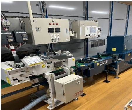
海苔製造過程での異物・形状合体型の検出選別機により品質が向上。
