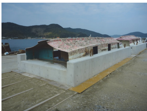
写真-4.3 FRP 沈船魚礁(第二南海丸)
