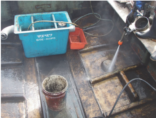
写真-5.4 洗浄状況(油処理剤散布)
