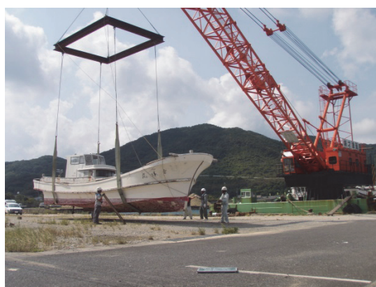
写真-5.3 FRP 漁船の製作ヤード陸揚げ状況
