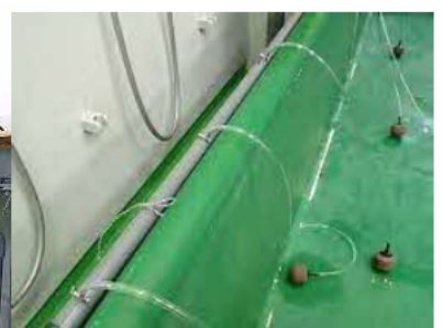
図3 エアーポンプに接続された複数のエアチューブの状況(左)と、エアレーションの改修後(中央、右)
