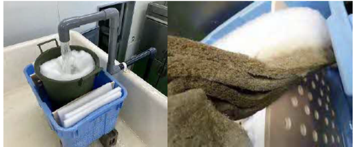
図2 上段水槽に設置した簡易ろ過装置とろ材の汚濁状況
