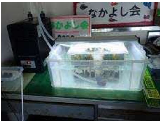
図15 ウォーターバス方式(外側の水を冷却することで中の採苗水槽を冷却する)
