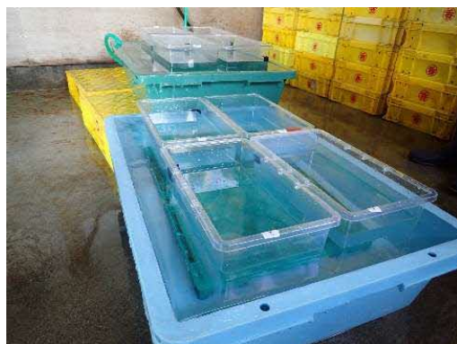
写真4 ウォーターバスによる昇温対策
