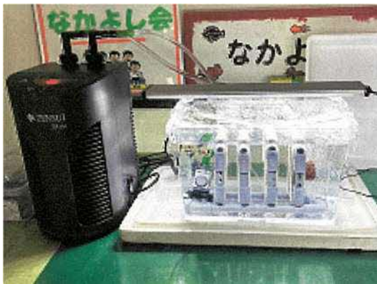
図1 水槽の設置状況(塩ビ管型採苗器)
