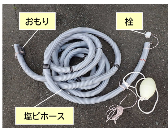
図2 新たなプランクトン調査に用いたホース式採水器及び情報提供様式
