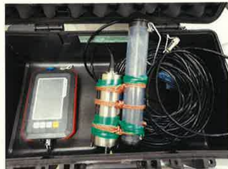
図 3 . 赤潮プランクトン計測機器
