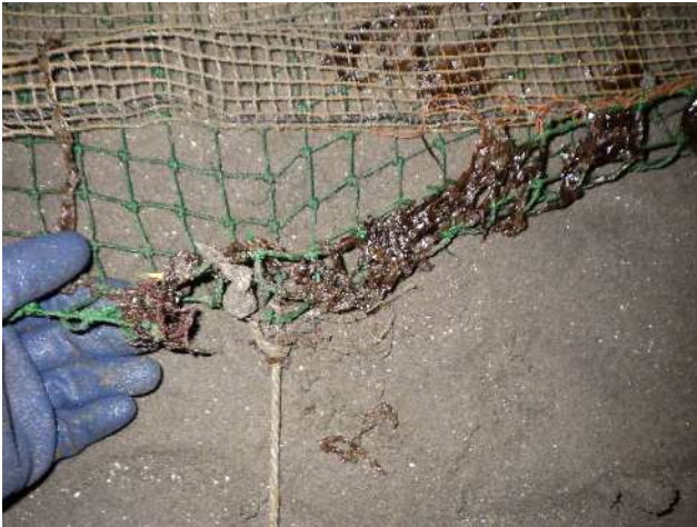
写真 3 破損した保護網
