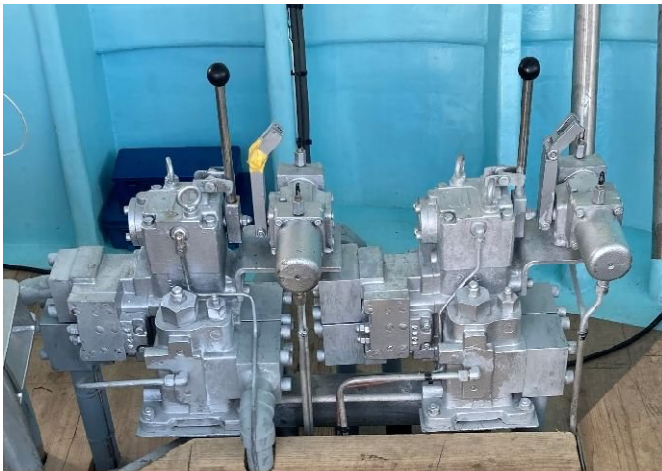
パースウインチ機側操作弁 + 油圧リモコン受動器
