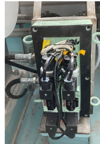
電磁比例圧力制御方向切換弁 (350×170×300mm, 約45kg)
