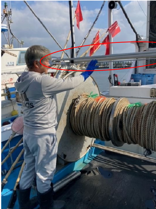
小型底びき網漁船 メインウィンチの安全バー
