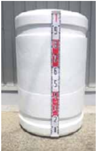
生分解性プラスチックを用いたフロートの試作品と実証試験 (写真提供：公益財団法人海と渚環境美化・油濁対策機構)
