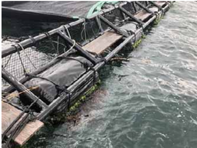
生分解性プラスチックを用いたフロートの試作品と実証試験 (写真提供：公益財団法人海と渚環境美化・油濁対策機構)
