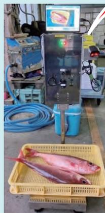
自動計量器による重量の情報に加えて、付随するカメラで撮影した写真をAIにより魚種判別を行い魚種の情報及び画像を収集。
