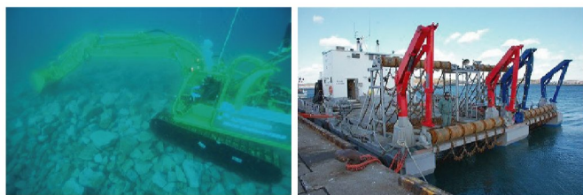
基質に付着した小型海藻やカキ・フジツボなどのかき落としなどで利用される水中バックホウ（左）、コンブ漁場の雑藻駆除で利用されている雑藻駆除船（右）
