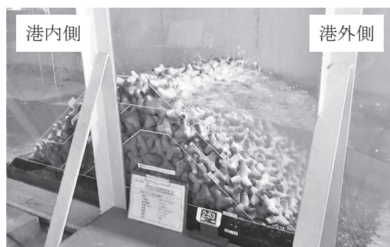
写真-3 現況断面の越波状況(ケース①-1、5工区)
