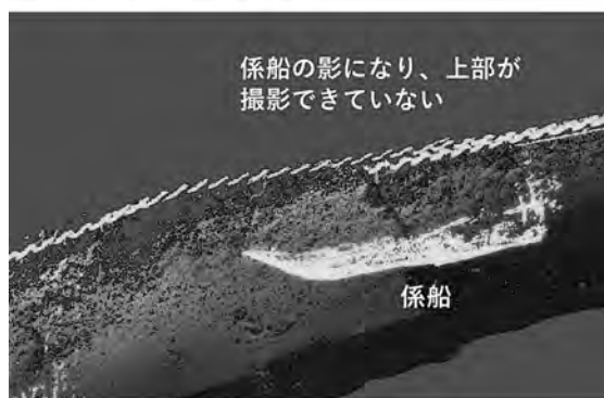
蛇行→計測データに歪み
