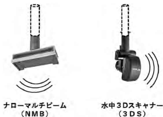
写真-1 NMBおよび3DSの機器外観
