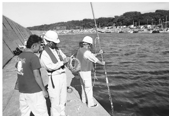
写真－8 垂下式カメラによる撮影状況
