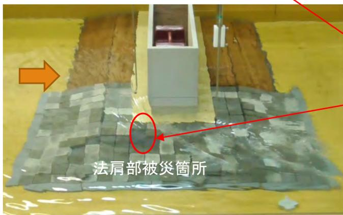
法肩部では、計算による流速が大きい地点と実験の被災箇所が一致
