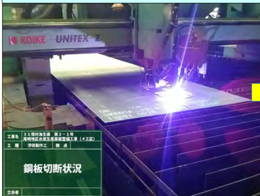
① 鋼材搬入・切断・加工
