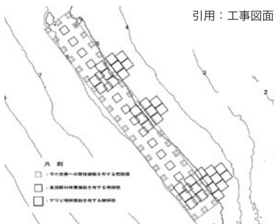
図－2 ブロック配置図の一部
