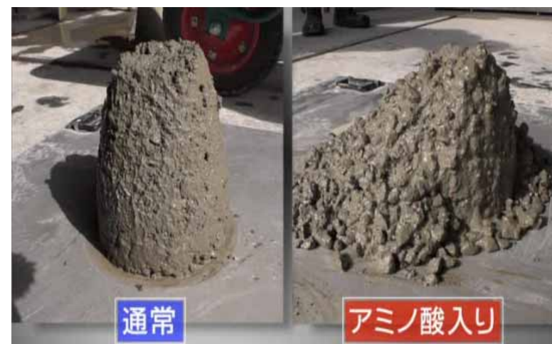
アミノ酸の有無によるスランプ試験結果 (アミノ酸の種類や配合によっては硬化しない)
