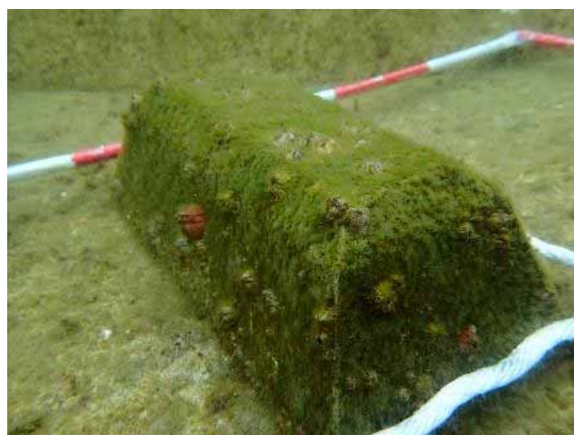
混和したアミノ酸（1種類）の溶出による 微細藻類の繁茂状況
