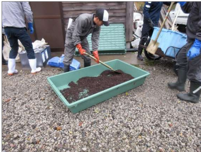
粉碎したウニ殻 自然乾燥させたウニ殻をスコップ等で粉碎する
