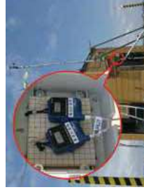
築堤基礎改良工事 (風向風速計測:0~5V)
