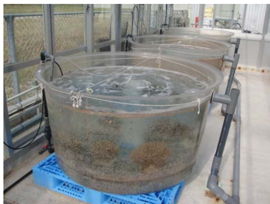
写真-V.2.3.2 親サンゴ飼育水槽 (1トン・ポリカーボネイト水槽)
