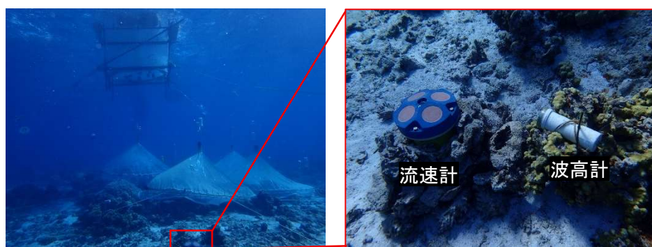
図-IV.1.2.3 波高計・流速計の設置状況
