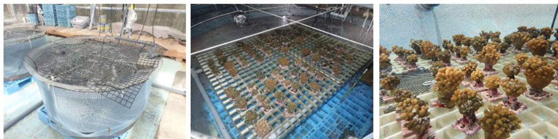
実験水槽(1トンポリカーボネイト水槽)
