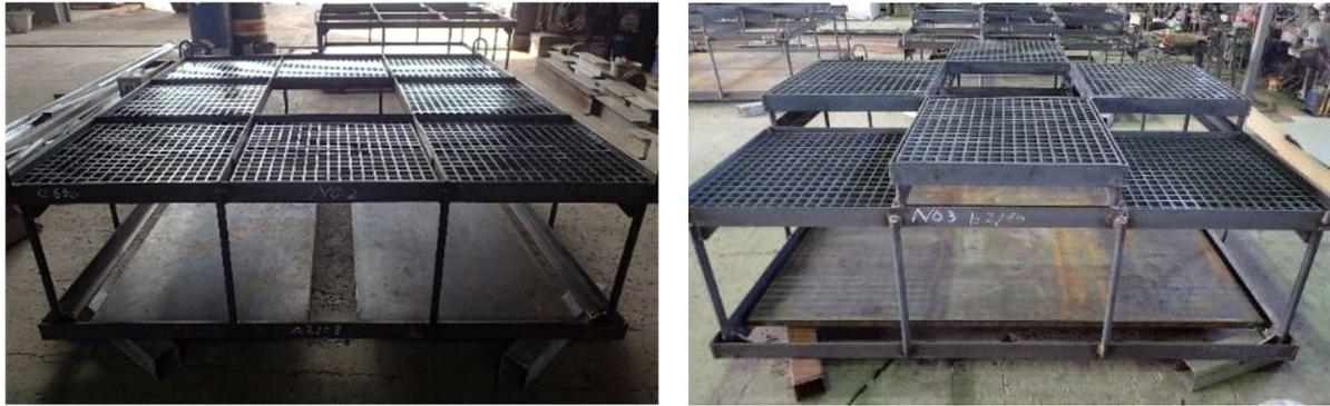
図4 標準2タイプの形状（左：平型、右：凸凹型）
