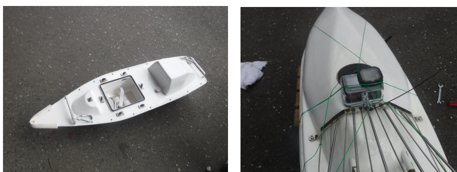
リモコンボート及びカメラ取付状況
